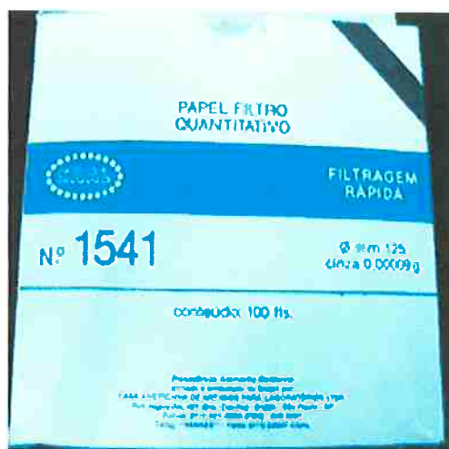
Figura 4.14 – Filtro da CAAL usado na separação das soluções dos sólidos
