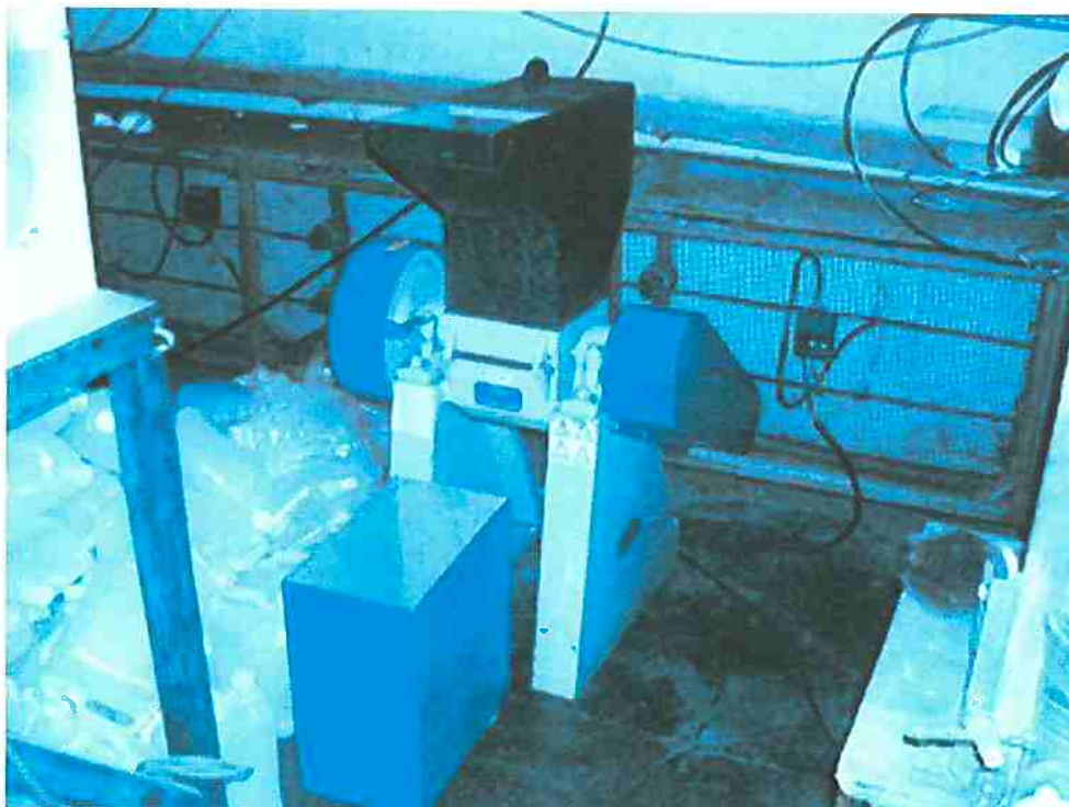
Figura 4.2 – Moedor de Facas usado na preparação das amostras
