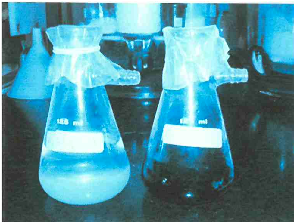
Figura 4.10 – Amostras de soluções, pH=1 a frio (esquerda) e água-régia (direita)
