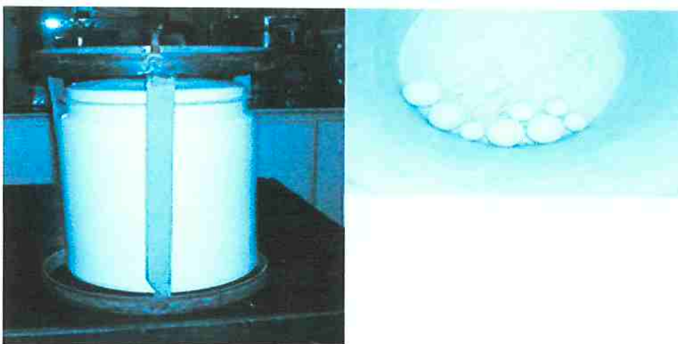
Figura 4.8 – Tambor montado e esferas cerâmicas no interior do misturador
